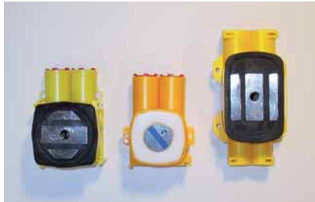
Figur 17. Vægelementer produceres overvejende på støbeborde af stål. Udsparinger, indstøbningsdele m.v. kan fastholdes til støbeformen med magneter. Der fås magneter til FUGA, OPUS og GLIM indstøbningsdåser. Billeder viser OPUS 1M, FUGA 1M og 1½M (gl. type) med ilagte magneter. Alternativt kan dåserne (dåselågene) klæbes til formen. Generelt er det nemmere at fastholde el-dåserne i formsiden end i op siden, og placering i formsiden er ofte mere præcis end placering i op siden. Hvis ikke andre hensyn taler imod det, så tilstræber man at producere elementerne sådan, at den vægside, der har flest indstøbninger, vender ned mod støbeformen.
